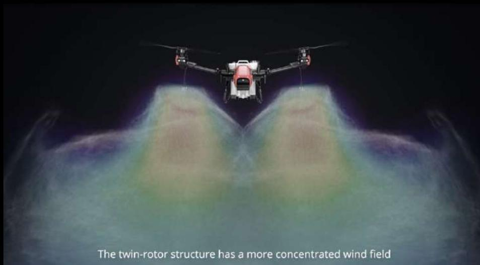
Inoltre, il potente flusso d'aria di circa 100 m<sup>3</sup> al secondo, prodotto dalle eliche, genera un vortice in grado di penetrare anche tra le foglie più interne delle piante, garantendo una copertura uniforme ed efficace. Questo sistema rende il drone particolarmente adatto per l'uso in agricoltura di precisione, ottimizzando l'efficacia del trattamento."
