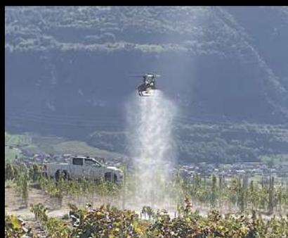
L'altitudine di volo rappresenta l'altezza del drone UAV rispetto al terreno (suolo) e alla chioma delle piante. Questo parametro è fondamentale per il controllo della distribuzione del prodotto spruzzato, poiché influisce sulla precisione con cui il liquido raggiunge le superfici delle piante. Un'altitudine correttamente calibrata permette di ottimizzare la copertura del prodotto, riducendo l'effetto deriva e garantendo un'applicazione più mirata ed efficiente.
